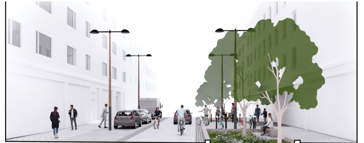
Kivetty jalkakäytävä 3 m Kapea joustoalue 3 m Kivetty ajorata 4 m Leveä joustoalue 4,5 m Kivetty jalkakäytävä 3 m
